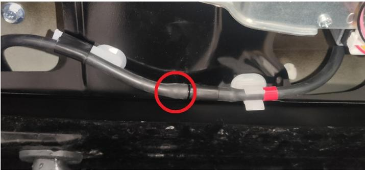
10. УСТАНОВИТЕ КАМЕРУ С КРОНШТЕЙНОМ В ШТАТНОЕ МЕСТО. ВКЛЮЧИТЕ ОМЫВАТЕЛЬ ЗАДНЕГО СТЕКЛА, УБЕДИТЕСЬ В ОТСУТСТВИИ ТЕЧЕЙ. СБОРКА АВТО ОСУЩЕСТВЛЯЕТСЯ В ОБРАТНОЙ ПОСЛЕДОВАТЕЛЬНОСТИ (ПРИ СБОРКЕ УБЕДИТЕСЬ ЧТО УСТАНАВЛИВАЕМЫЕ НАКЛАДКИ НЕ ПЕРЕЖИМАЮТ ШЛАНГ ПОДАЧИ ЖИДКОСТИ К ОМЫВАТЕЛЮ КАМЕРЫ). ПРИ НЕОБХОДИМОСТИ ОТРЕГУЛИРУЙТЕ ПОЛОЖЕНИЕ ШАРИКА ДЛЯ НАИЛУЧШЕГО ОМЫВАНИЯ КАМЕРЫ
