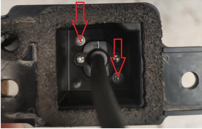
8. СНИМИТЕ ШЛАНГ С ШТАТНОГО ОБРАТНОГО КЛАПАНА И УСТАНОВИТЕ ТРОЙНИК ИЗ КОМПЛЕКТА, СОЕДИНИВ ЕГО СО ШТАТНЫМ КЛАПАНОМ КУСКОМ ШЛАНГА.
