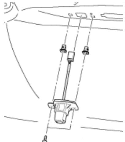
6. ОТВЕРНИТЕ 2 ВИНТА КРЕПЛЕНИЯ КАМЕРЫ К КРОНШТЕЙНУ И СНИМИТЕ КАМЕРУ
