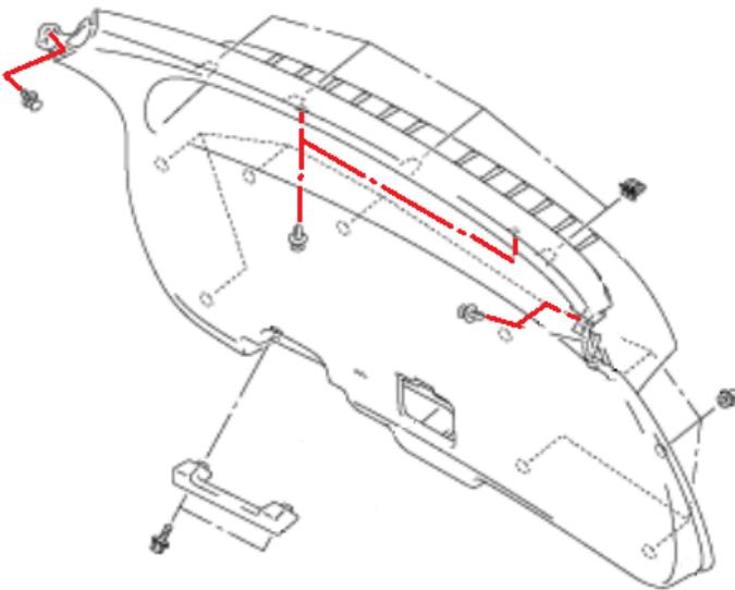
4. ВЫВЕРНИТЕ 2 БОЛТА И 2 ГАЙКИ КРЕПЛЕНИЯ НАРУЖНОЙ НАКЛАДКИ КРЫШКИ БАГАЖНИКА И СНИМИТЕ ЕЕ.
