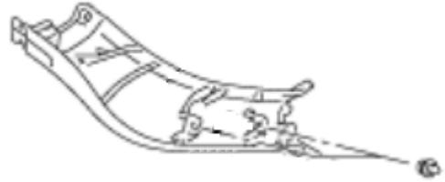
3. ВЫВЕРНИТЕ 2 БОЛТА КРЕПЛЕНИЯ РУЧКИ И СНИМИТЕ ЕЕ. ОСВОБОДИТЕ 4 КЛИПСЫ СНИМИТЕ ПАНЕЛЬ ОБЛИЦОВКИ ДВЕРИ БАГАЖНОГО ОТДЕЛЕНИЯ
